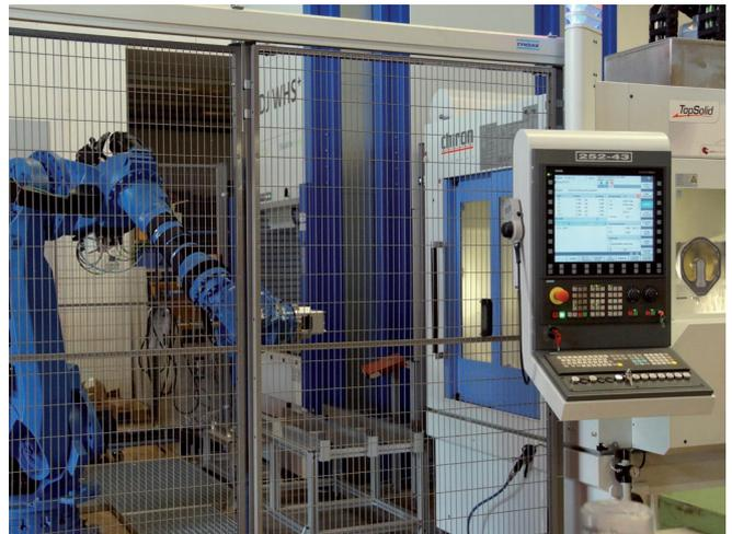
Fertigungszelle mit Chiron Fräscnter und 6-Achs Knickarm-Roboter
